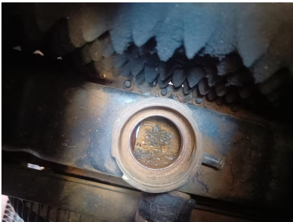
Foto N° 8 (entrada de radiador con presencia de oxido)
